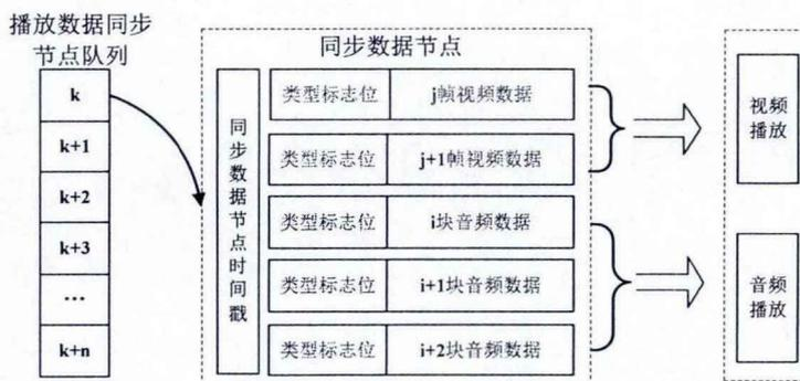
图 3-13 对解码后的同步数据节点进行实时播放的过程
