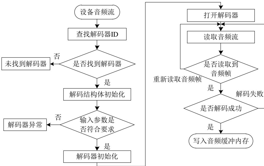
图 4.11 音频解码流程
