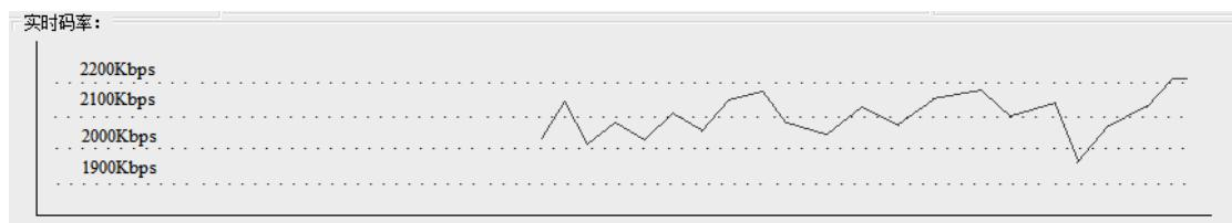
图 6.5 实时编码速率曲线图
