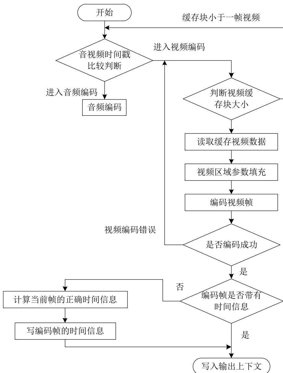
图 4.15 H.264 视频编码实现流程图
