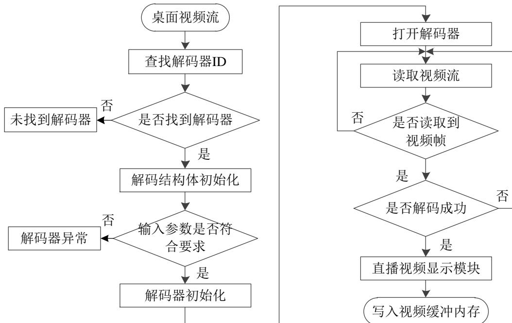
图 4.9 视频解码流程图
