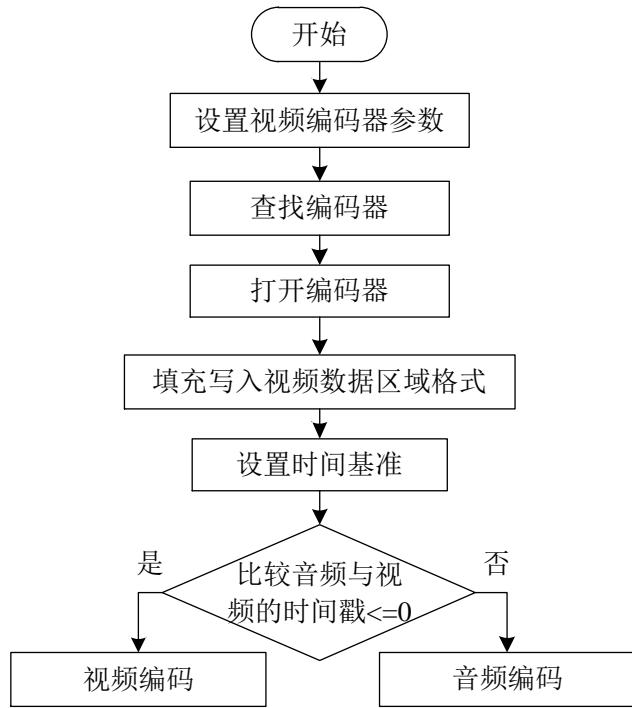
图 4.12 音视频编码模块流程
